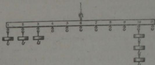
Fig. 26. — L'équilibre de la barre de bois peut être réalisé de bien des manières; il l'est toujours quand on oppose, en son point de suspension, des couples égaux.
