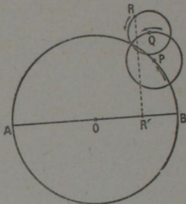
Fig. 38. — Les mouvements oscillatoires les plus compliqués peuvent être représentés par le mouvement d'une dent de roue dans un engrenage.
