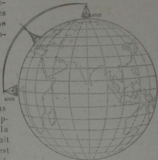
Fig. 24. — A l'équateur, une tonne pèse 5 kg de plus qu'au pôle.
