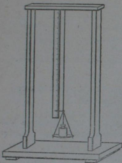
Fig. 45. — On peut étudier les propriétés mécaniques des métaux en mesurant l'allongement que subit un fil chargé d'un poids.
