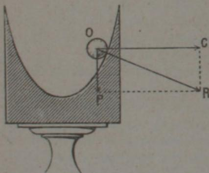
Fig. 35. — Une bille est en équilibre à la surface d'un paraboloïde tournant à une vitesse convenable.
