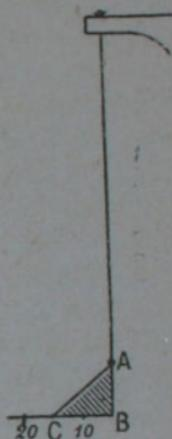
Fig. 47. — Dans la rupture par choc, un fil métallique commence par emmagasiner l'énergie cinétique du corps qui le frappe.
