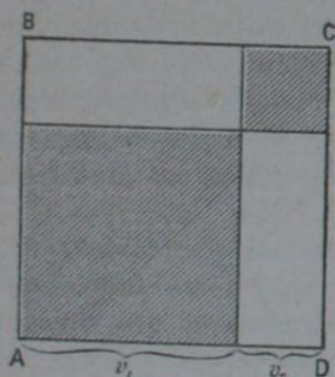
Fig. 43. — Les surfaces hachurées représentent la proportion du travail récupéré dans le choc non élastique.
