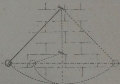
Fig. 14. — La masse d'un pendule remonte sensiblement au niveau de son point de départ.
