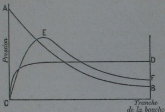
Fig. 49 — L'effet balistique et l'effet brisant dépendent du développement de la pression dans une arme à feu.
