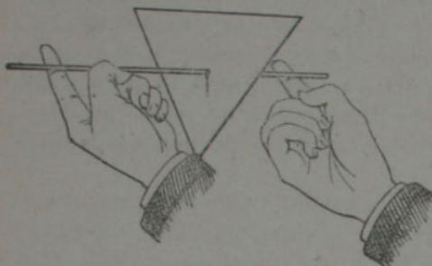
Fig. 29. — Un corps soutenu par son centre de gravité n'a aucune tendance à tourner de lui-même.
